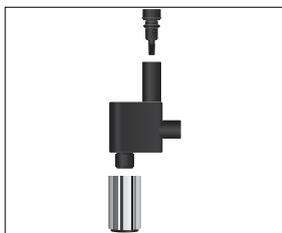
Per fare in modo che l'ugello per microschiama funzioni correttamente e per motivi igienici, è obbligatorio scomporlo e sciacquarlo **giornalmente** se è stato utilizzato per preparare il latte. L'IMPRESSA non segnala la necessità di scomporre e sciacquare l'ugello per microschiama.
